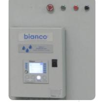
5-BIANCO 布面湿度监测和控制系统。可检测出布的烘干效果和湿度,调整机器速度以及抽湿风机的运行,减少人工干预对质量和产能的影响。
