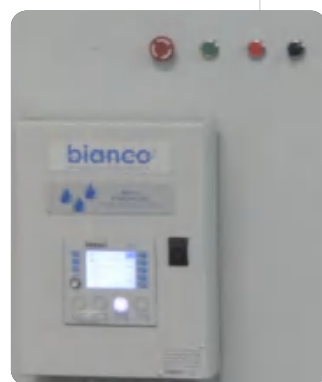
5-BIANCO 布面湿度监测和控制系统。可检测出布的烘干效果和湿度，调整机器速度以及抽湿风机的运行，减少人工干预对质量和产能的影响。
